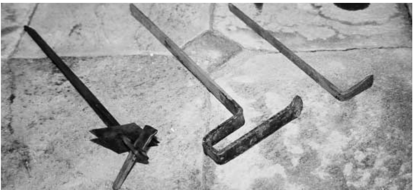
せき板金物／左から改良型カンザシ、新式イナズマ、古式コズナ
